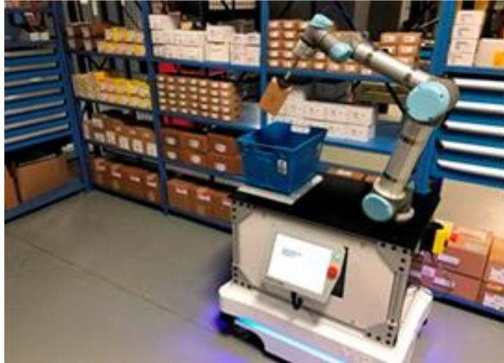
**Figura 1.39** Robot móvil Mir100 con brazo robótico UR3 que recoge artículos en un almacén.
