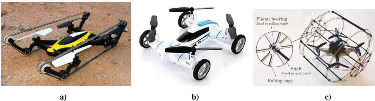
**Figura 1.22** Ejemplos de robots móviles híbridos: **a)** Orugas y hélices (aditivo), **b)** Ruedas y hélices (aditivo), **c)** Rodillo y hélices (semi-aditivo).
