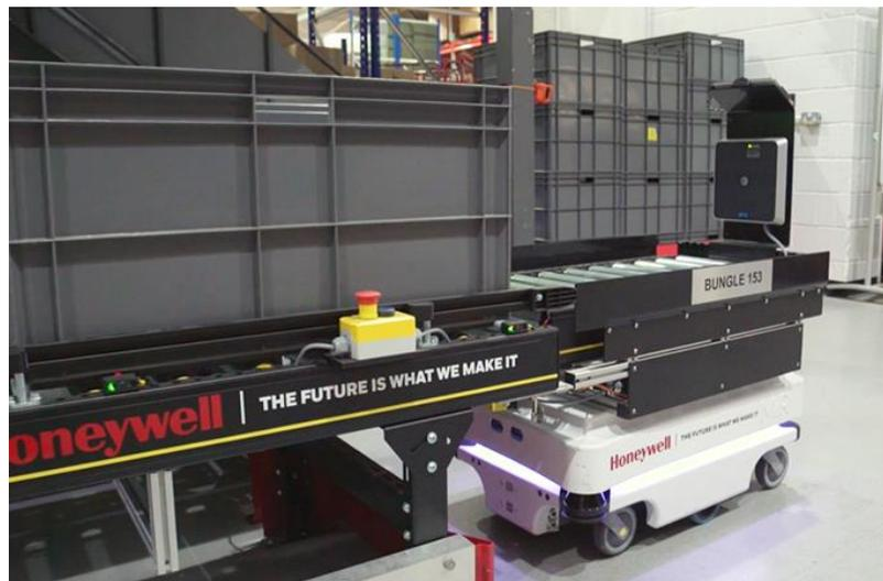
**Figura 1.38** Robot móvil MiR100 equipado con una cinta transportadora en Honeywell Safety and Productivity Solutions.
