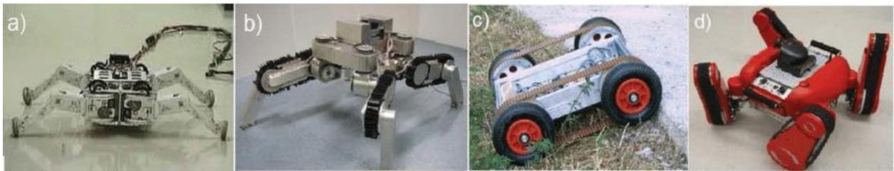
**Figura 1.18** Algunos ejemplos de configuraciones de robots móviles terrestres híbridos: **a)** patas con ruedas, **b)** patas con orugas, **c)** ruedas con orugas, **d)** patas con ruedas y orugas [10].
