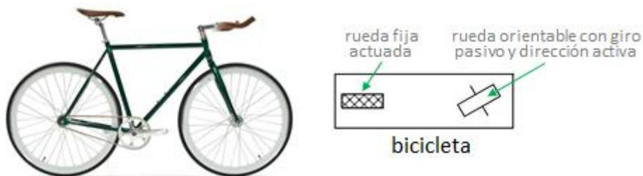
**Figura 2.11** Ejemplo de un robot tipo bicicleta.
