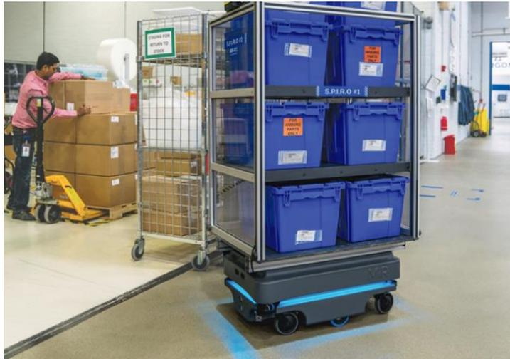
**Figura 1.36** Robot móvil MiR200 con un estante estático que transporta instrumentos quirúrgicos entre el almacén y la producción en Argón Medical en Chicago.
