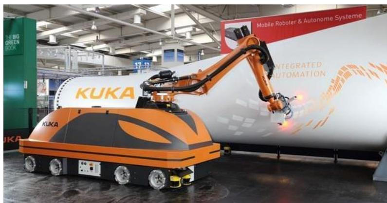
**Figura 1.50** Robot móvil manipulador KUKA MOIROS en el proceso de pulido de una sección de una aeronave.
