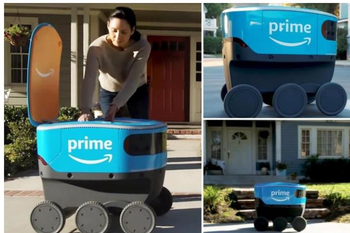
**Figura 1.45** Robot móvil con ruedas Amazon Scout utilizado para transporte y entrega de paquetes.
