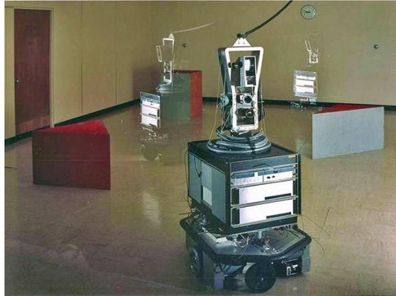
**Figura 1.25** Robot móvil con ruedas Shakey.
