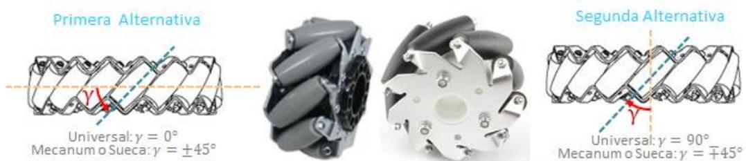
**Figura 2.5** Rueda omnidireccional tipo mecanum o sueca.
