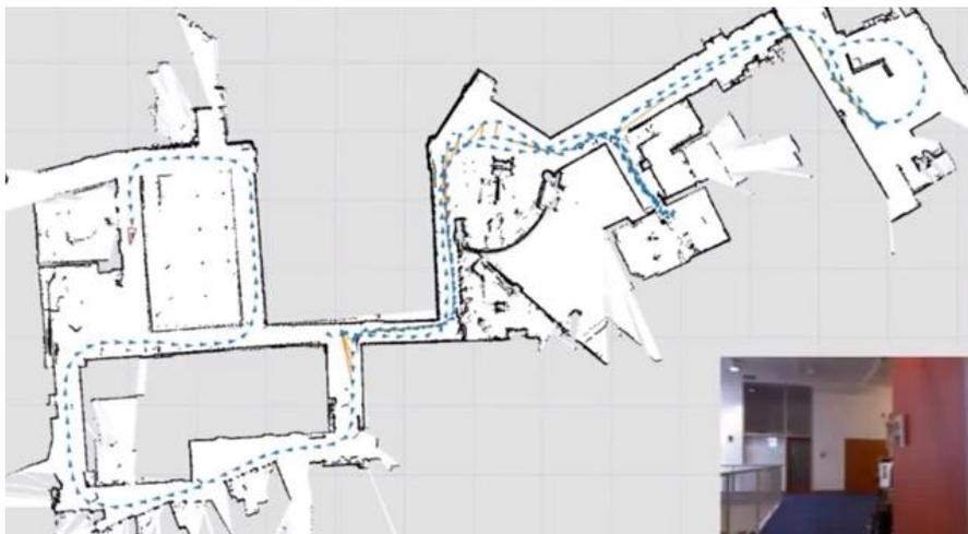
**Figura 1.12** Ejemplo de SLAM empleando un sensor Kinect acoplado a bordo de un robot móvil.
