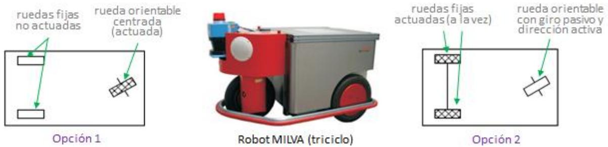
**Figura 2.15** Robot MILVA de tres ruedas tipo triciclo.
