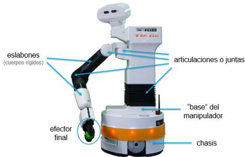
**Figura 1.8** Elementos que conforman el sistema mecánico de un robot móvil manipulador (Robot TIAGO - PAL Robotics).
