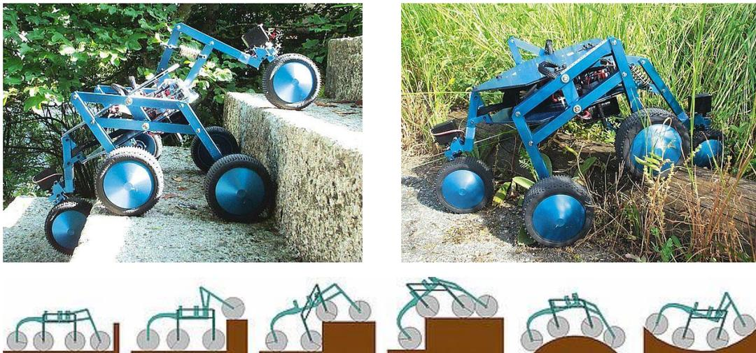
**Figura 2.36** Un robot móvil híbrido para terrenos accidentados formado por patas y ruedas (Shrimp III).
