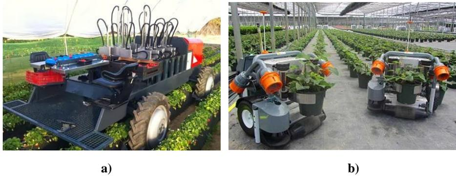
**Figura 1.42 a)** Recolectora automática de fresas (Agrobot), **b)** Vivero automatizado (Harvest Automation).
