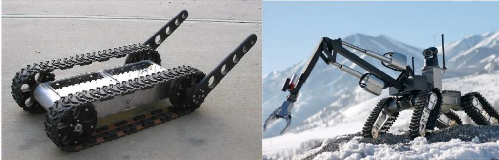
**Figura 2.35** Ejemplos de robots móviles con orugas basados en sistemas de brazo estabilizador de aletas.
