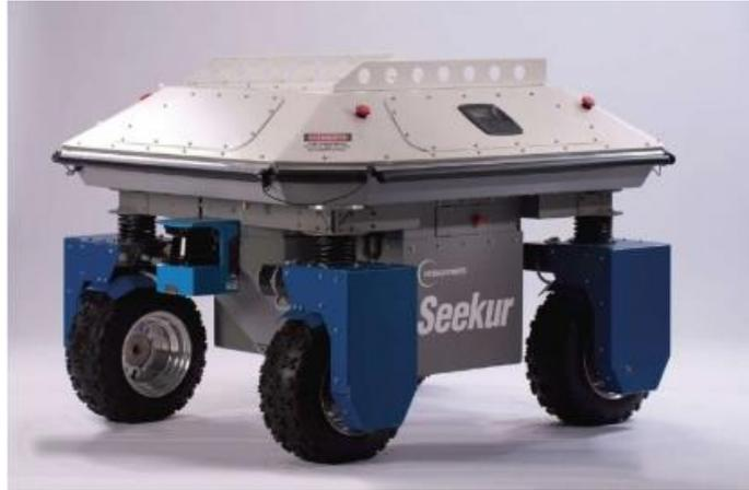
**Figura 2.32** Ejemplo de un robot omnidireccional con cuatro ruedas orientables centradas (robot Seekur de Adept MobileRobots).
