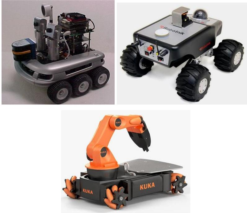
**Figura 1.16** Algunos ejemplos de configuraciones de robots móviles con ruedas con y sin manipulador.
