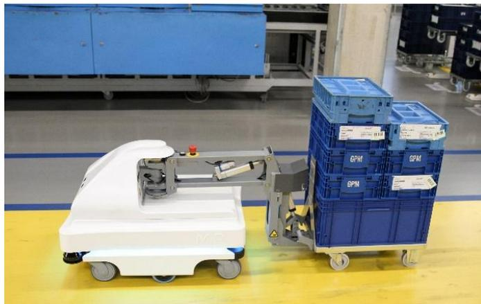
**Figura 1.37** Robot móvil Mir100 con sistema MiRHooK que remolca pallets. Puede detectar, cargar y descargar la horquilla para pallet de forma autónoma.
