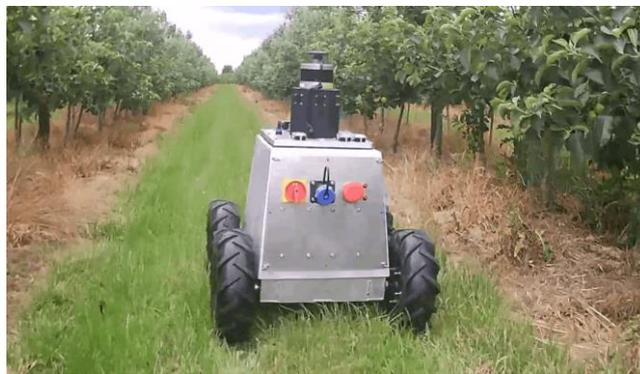
**Figura 1.43** Robot móvil con ruedas Mamut aplicado en campo de la agricultura.
