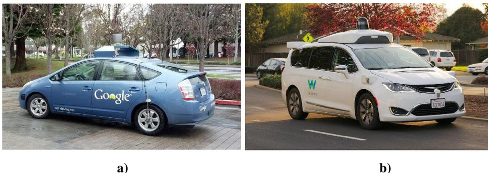
**Figura 1.44 a)** Primera generación de Google Car adaptando un coche comercial (Toyota Prius), **b)** Waymo One diseñado para ser autónomo (sin volante ni pedales).
